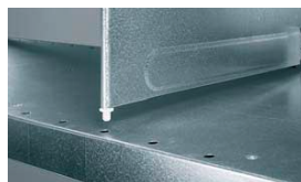
Serienmäßige Fachbodenbohrung in Breitenrichtung im Raster 50:50 mm bei allen Fachböden mit 40 mm Abkantung. Dadurch lassen sich Stecktrennwände zur individuellen Fachunterteilung problemlos und flexibel einstecken.
