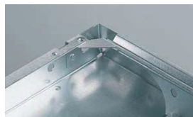
Konstruktiv aufwendige Fachbodenecke mit durchgehender Überlappung durch den zusätzlichen Eckensteg.
