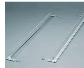
Breitenriegel. Bei Regalen mit Zugriff von beiden Seiten würde eine Kreuzdiagonale nur stören. Hier verwendet man Breitenriegel, die die Seitenrahmen in Breitenrichtung miteinander verbinden.
